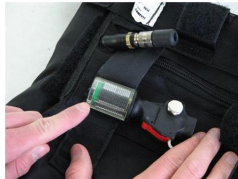
**Figure 4.4 :** Bouchon du mécanisme de gonflage automatique avec l'indicateur vert
