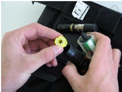
**Figure 4.3 :** Remplacement de la bobine
