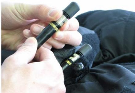
**Figure 3.4 :** *Fermeture du verrou de sûreté de la soupape buccale de gonflage*
