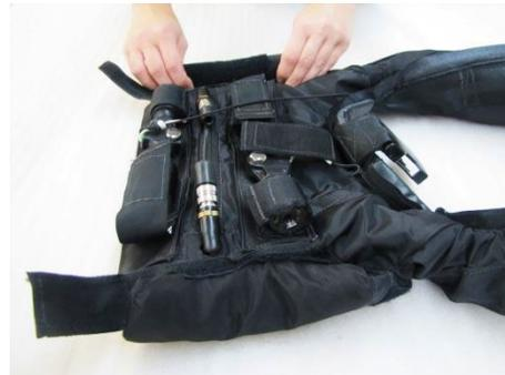
8. À cette étape-ci, les cylindres de CO<sub>2</sub> épuisés sont à retirer. En commençant par le dispositif de gonflage supérieur, ouvrir la gaine en toile couvrant le cylindre de CO<sub>2</sub> et dévisser ce dernier du mécanisme de gonflage.
