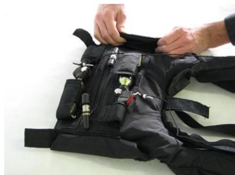
5. Rouler le lobe de tête depuis le haut vers le châssis. Le fixer en position roulée en arrimant la bande de fixation à crochets au centre (Fig. 4.14) et les deux bandes de chaque côté, aux fixations de boucles à l'arrière du lobe de tête (Fig. 4.15).
