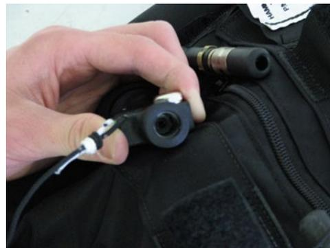
7. Avant de monter un nouveau cylindre, en examiner la surface de contact. S'assurer qu'elle est lisse, sans perforation ni égratignure.
