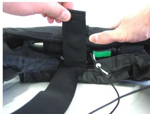
7. Séparer la bande de fixation auto-agrippante en utilisant les tirettes pour ouvrir les gaines des cordons de gonflage. Placer le cordon dans la gaine en commençant par les poignées en remontant vers le lobe de tête. L'excès de cordon peut être rangé dans le lobe de tête, tout en s'assurant que le cordon sera libre de fonctionner lorsque les poignées seront tirées.
