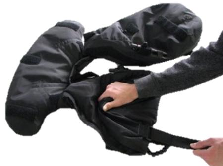
4. Rouler le lobe autour du tube buccal vers la bande de fixation (Fig. 3.7). Une fois le lobe complètement roulé, bien le fixer à l'aide des bandes de fixation auto-agrippantes (Fig. 3.8). À ce moment-ci, il ne devrait pas y avoir de gaz dans ce lobe de poitrine. En pliant ce lobe, le gaz passe dans l'autre lobe de poitrine et le lobe de tête, empêchant ainsi au gaz d'entrer de nouveau.
