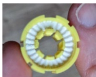
Figure 26 - (Image 1) – Ouverture sur le système de gonflage pour la bobine / (Image 2) bobine à pastille de sel / (Image 3) Système de gonflage armé en mode automatique
