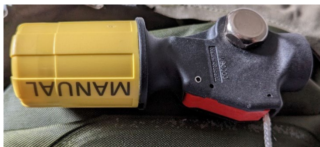
Figure 24 – Système de gonflage en mode manuel
