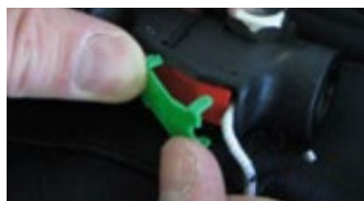
Figure 27 – Installation de la pince d'indication verte
