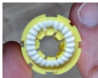
Figure 26 - (Image 1) – Ouverture sur le système de gonflage pour la bobine / (Image 2) bobine à pastille de sel / (Image 3) Système de gonflage armé en mode automatique
