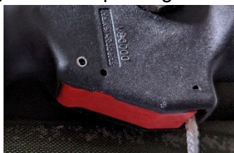
Figure 23 – Levier rouge du système de gonflage en position fermé
