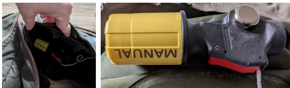
Figure 24 – Système de gonflage en mode manuel
