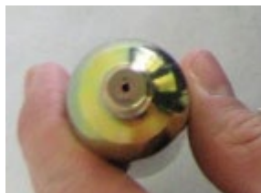
Figure 21: Cartouche percée / utilisée
